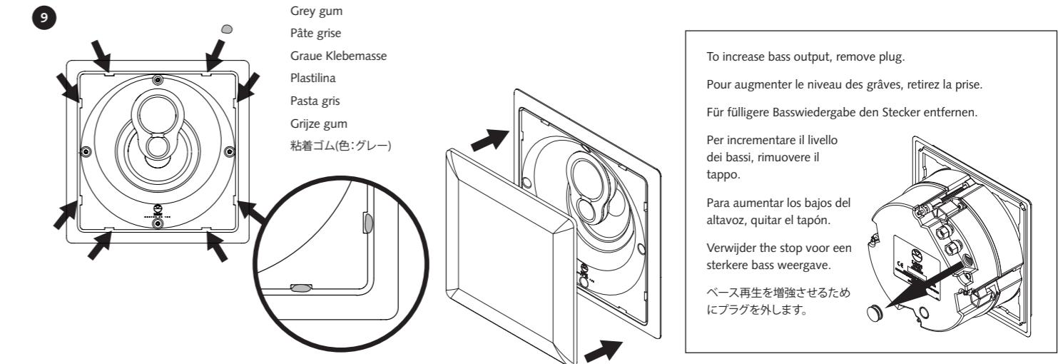
NOTES FOR CEILING INSTALLATION • REMARQUE SUR L'INSTALLATION AU PLAFOND • HINWEIS FÜR DECKENEINBAU
